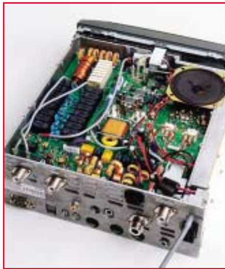
Bild 4: Filtern ist auch im HF-Ausgang alles: Die Oberseite des Transceivers wird beinahe beherrscht von der Filterbank.
