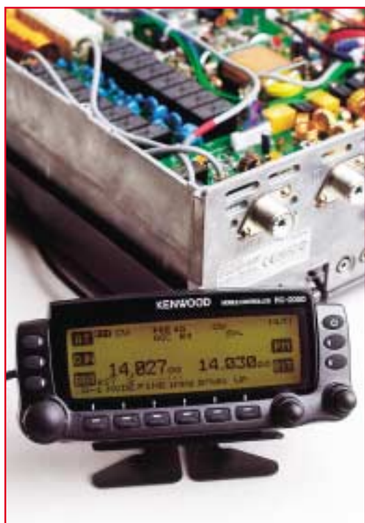
▲ Bild 2: Wie ein dienstbarer Frosch sieht die Fernbedienung aus, die über eine Leitung mit Western-Stecker mit dem Transceiver verbunden wird und dessen Bedienung beispielsweise im Mobilbetrieb erlaubt.
