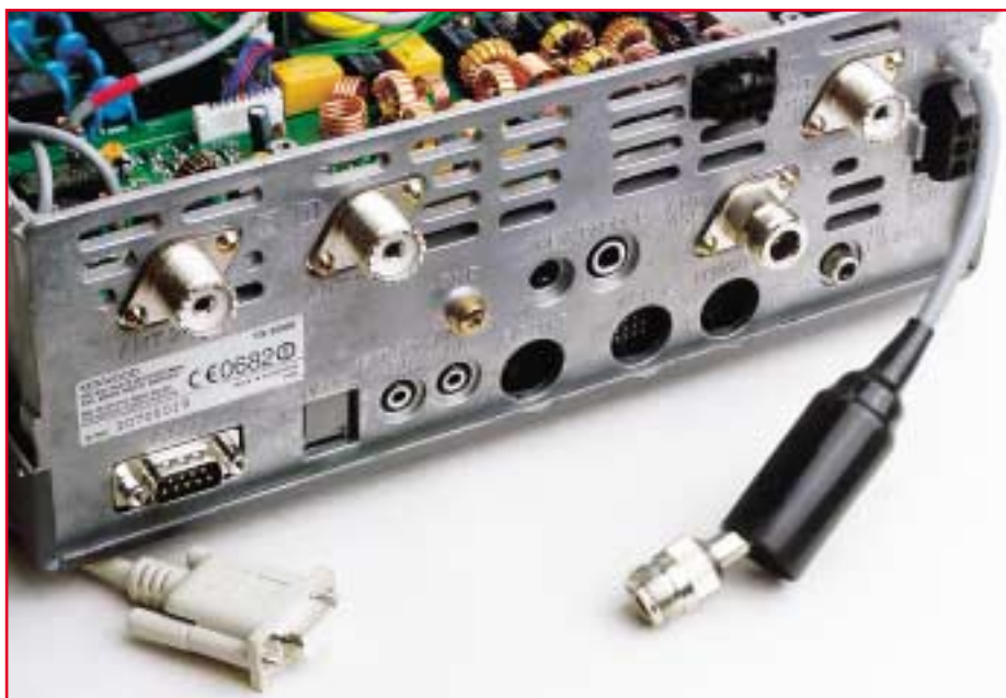
► Bild 3: Mit fünf Anschlüssen allein für die Antenne glänzt die Rückseite des TS-2000.
